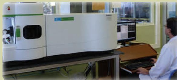
Una vez terminada la digestión, el rotor se deja enfriar, se abre el envase y el contenido totalmente digerido se trasvasa a un balón aforado, se lleva a volumen con agua desionizada y se agita, se realiza una dilución y se coloca en los recipientes del Espectrómetro de Emisión Atómica de Plasma (ICP-OES) y, mediante curvas de calibración apropiadas el equipo efectúa la lectura de **Fósforo**, y se obtiene los resultados de **concentración total** presente en la muestra.
