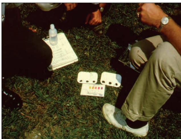
Foto 1. Método de determinación de pH por medio de papel indicador.
